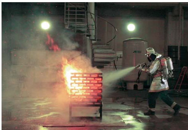
横浜市安全管理局による二流体混合噴霧消火システムの実験
